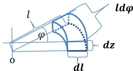
図 28. 円筒座標の求積法での積分ユニット
